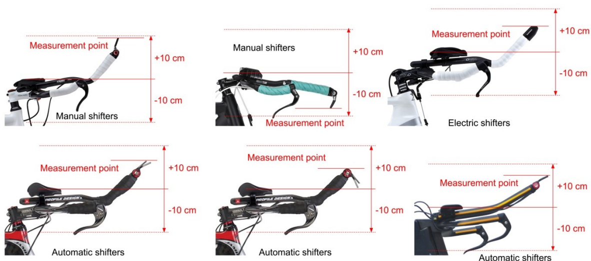
Figure 38 : Points de mesure des limites verticales des prolongateurs avec tous leurs accessoires
