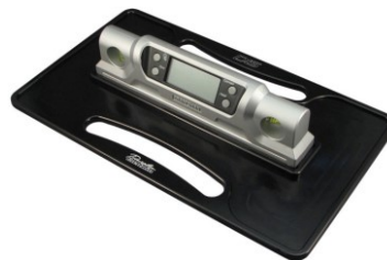
Figure 6 : Appareil de mesure officiel pour contrôler l'inclinaison des selles
