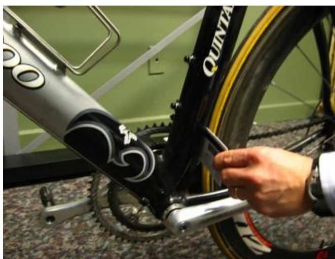
Figure 53 : Insertion d'une carte rigide entre la roue et le cadre afin de vérifier l'absence de carénage
