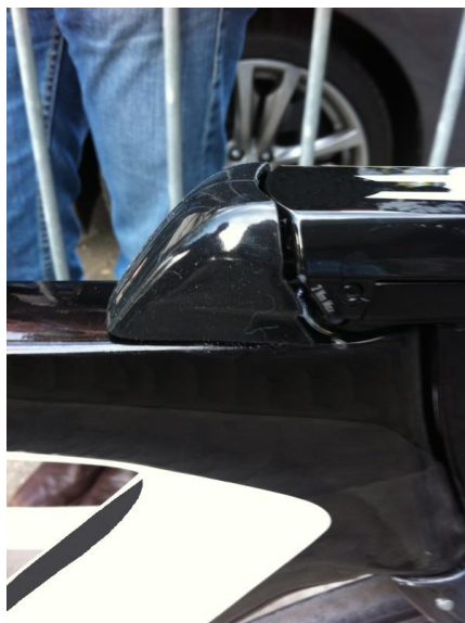
Figure 42 : Cache ajouté au cadre pour couvrir les câbles de frein
