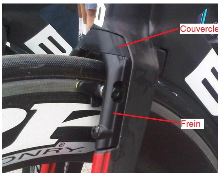
Figure 43 : Frein intégré à la fourche muni d'un couvercle
